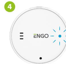
Lassen Sie die Tasten los, die SYNC-Funktion wird aktiviert (Synchronisation mit dem Kopf).
