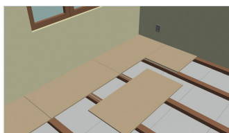
Platten quer zu den Lagerhölzern verlegen.
