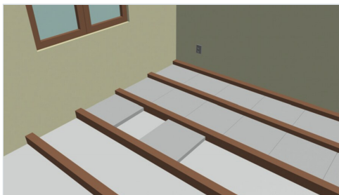
Dämmung bündig zwischen den Lagerhölzern eingelegt.
