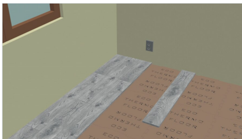
Direkt darauf folgt der schwimmend verlegte Oberbelag.
