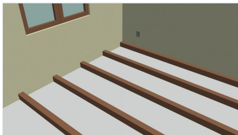
Ebener Untergrund mit ausgerichteten Lagerhölzern.
